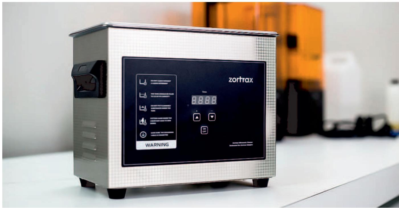
Zortrax Ultrasonic Cleaner este un dispozitiv care curata automat modelele, folosind unde sonore de inalta frecventa propagate intr-un lichid de curatare.
